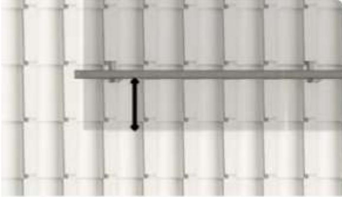
Soit pour le panneau SUNPOWER dont côté le plus long est 1996mm : rail à fixer entre 449mm et 548mm en perpendiculaire au côté le plus long du panneau
